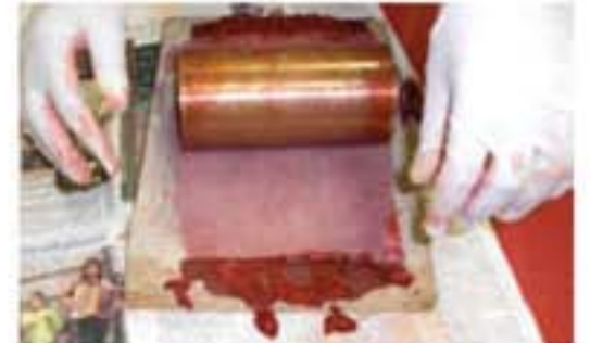
Kâğıt hamurunun merdaneyle suyunun atılması ve kurumaya bırakılması
