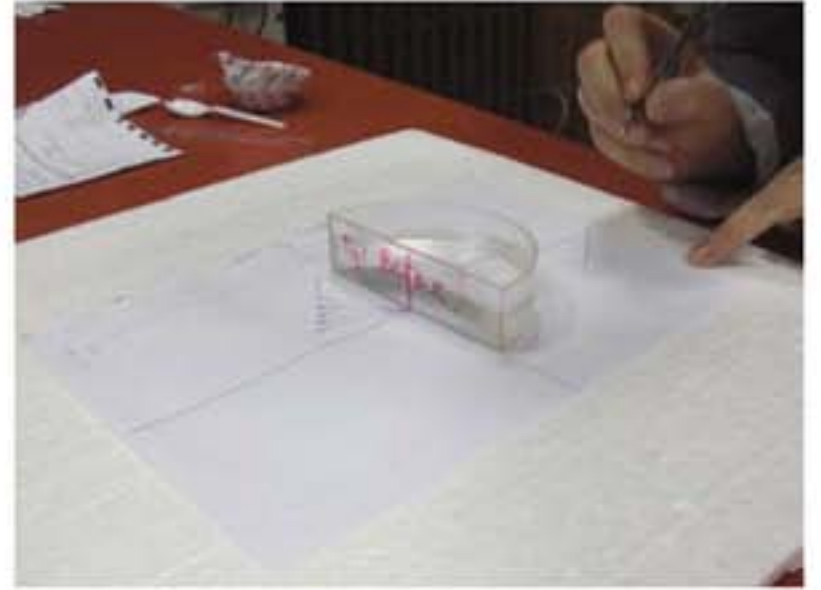
Boraks çözeltilerinin kırılma açılarının belirlenmesi
